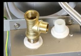
**Etape 9** — Appliquer un ruban PTFE autour des deux extrémités filetées sur l'électrovanne et visser à la vanne en T. Remarque: Le l'électrovanne doit absolument être installé comme sur l'image ,avec la plaque de montage en laiton au sommet.
