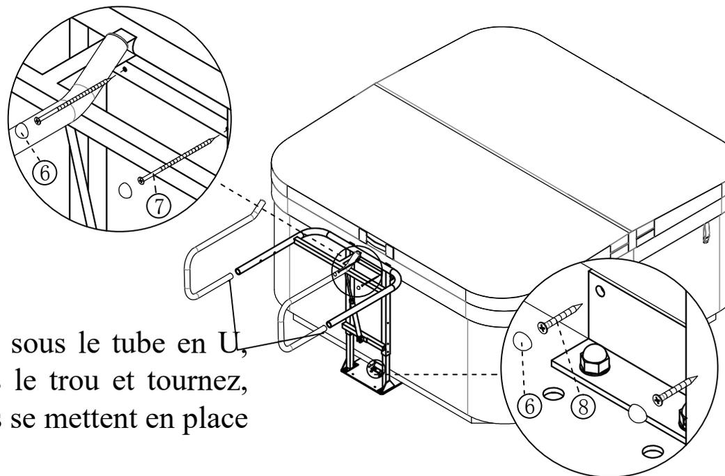
Appuyez sur les points saillants sous le tube en U, puis poussez le tube en U dans le trou et tournez, jusqu'à ce que les points saillants se mettent en place et ressortent.
