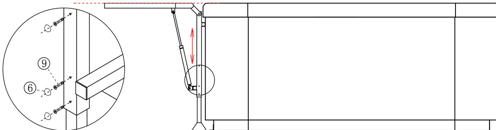
Insérez le produit dans le fond du spa, ajustez le cadre basculant de haut en bas pour que la position la plus haute soit unanime avec celle du spa, et verrouillez avec les vis.
