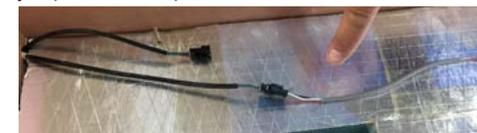
Un connecteur du circuit led reste non connecté, c'est normal ! le circuit led n'est pas un circuit fermé.
