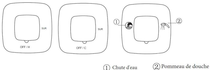
Commutateur de régulation d'eau chaude : le mot " ON" signifie eau chaude. Tourner autour du robinet pour régler la température de l'eau. "OFF/H" signifie que l'eau chaude est coupée.
