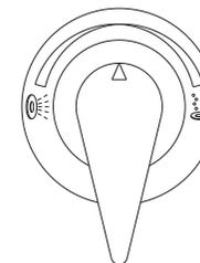
Débit d'air : La vanne a deux fonctions : Augmenter ou réduire la pression lorsque la pompe à air/ pompe à eau est en marche. Actionner dans un premier temps le panneau de commande afin d'activer les jets d'eau ou d'air puis régler la puissance des jets.
