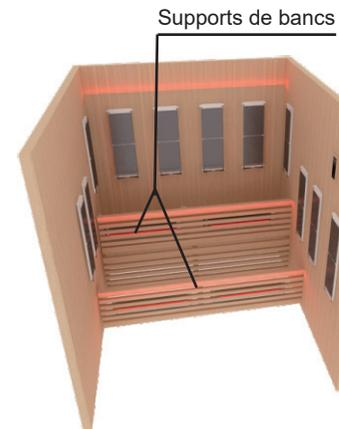
8 Positionner les bancs et brancher les LED à l'aide des câbles prévus à cet effet.
