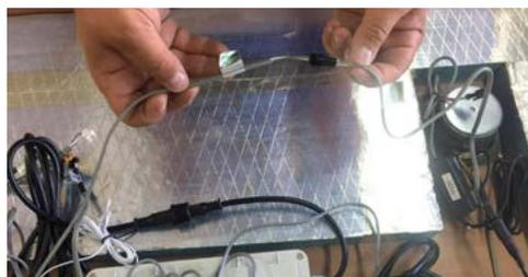
Connectez le câble «RGB signal connector» provenant du répartiteur au câble provenant du bloc LP5 (entrée - input)
