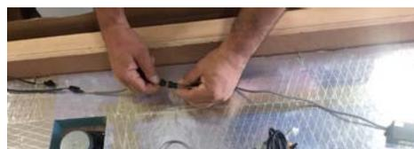
Connectez le câble croisé au câble provenant du bloc LP5 (output - sortie). Connectez ensuite l'autre extrémité du câble croisé au connecteur led mâle laissé libre jusqu'à cette étape.
