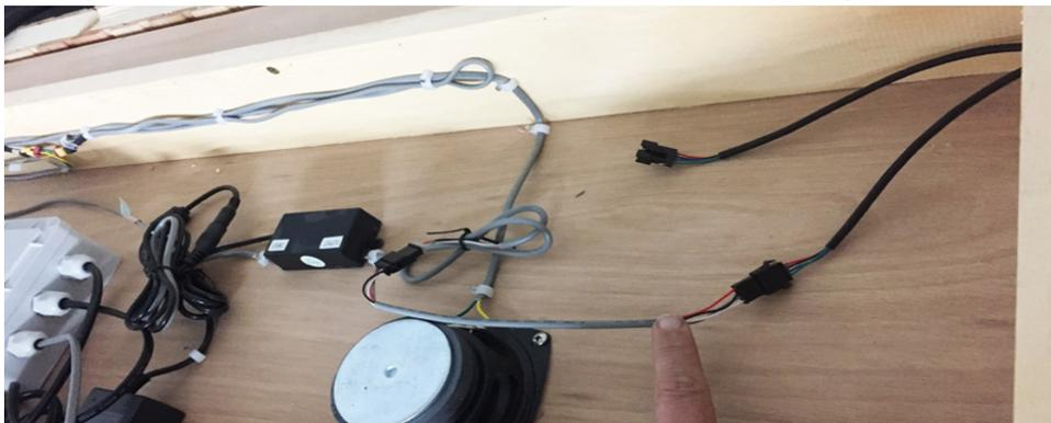
12. Connexion de la lampe : Faites passer le câble de la lampe par le trou du panneau latéral pour accéder au toit. Le raccorder ensuite au câble possédant l'étiquette de repérage ci-contre :
