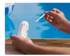
Lorsque vous décidez d'acheter un kit de test, il est important d'en choisir un compatible avec le mode de traitement que vous utilisez : brome, oxygène actif ou chllore.
